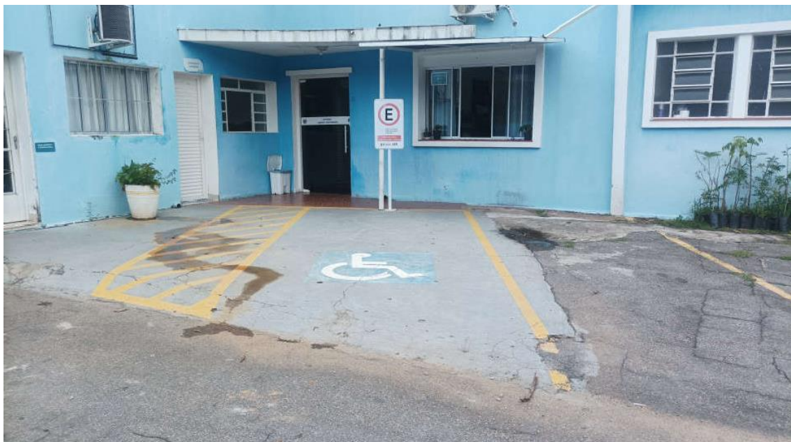
FOTO 5 – SINALIZAÇÃO VERTICAL EM DESCONFORMIDADE AO PADRÃO E A ALTURA NO ESTACIONAMENTO PARA USO FUNCIONÁRIOS
