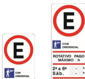
FIGURA 10 E 11 – MODELOS DE SINALIZAÇÃO VERTICAL DE VAGAS DE ESTACIONAMENTO DE VEÍCULOS DESTINADOS A IDOSOS, CONFORME RESOLUÇÃO 965/2022.
