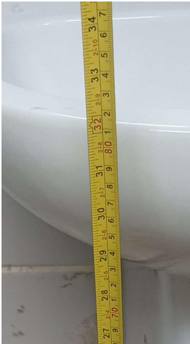
FOTOS 31 E 32 – BOXE SANITÁRIO DO BANHEIRO MASCULINO – ALTURA DO LAVATÓRIO EM DESCONFORMIDADE (Fonte: Tobias Soares Bádue).
