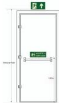
Sinalização de portas com barras antipânico
